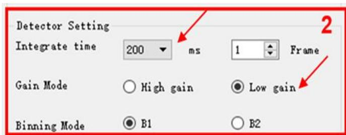
图 3.3.6 模块 2 中触发时间和采集模式设置
