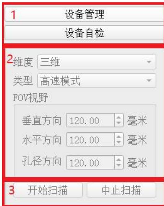
图 2.2.2 MPI 设备控制面板中的功能区
