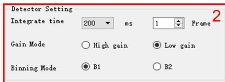
图 3.3.13 模块 2 中触发时间和采集模式设置
